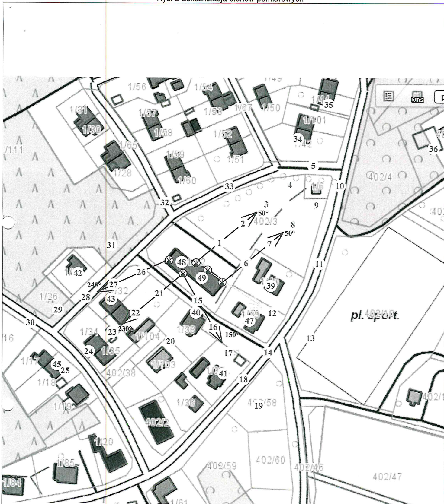
Rys. 2 Lokalizacja pionów pomiarowych
